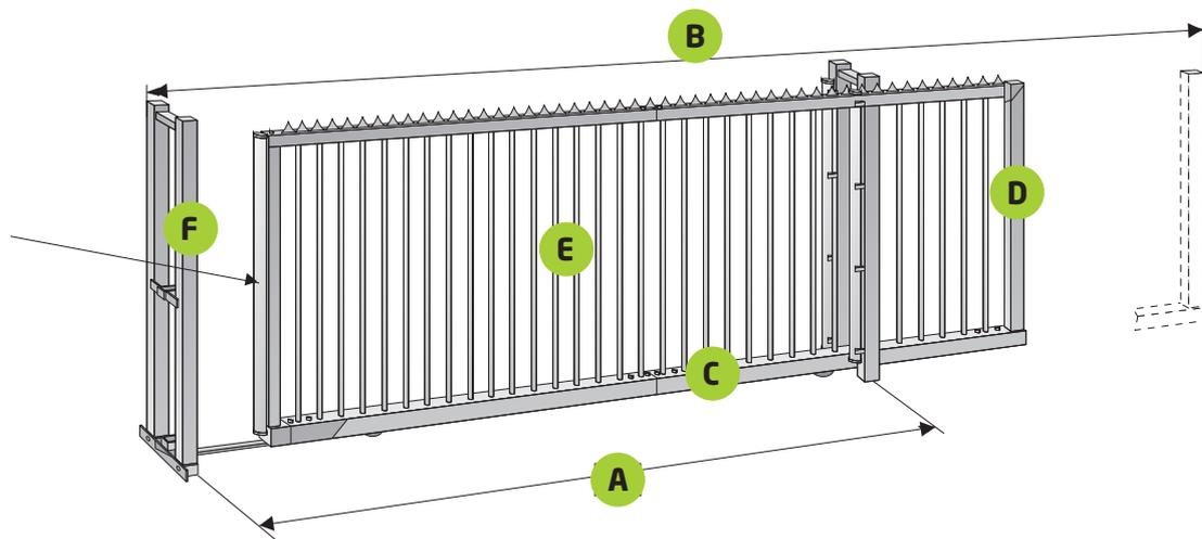
A - Abertura B - Dimensão total C - Perfil D - Perfil E - Tubo Verticais F - Torre
